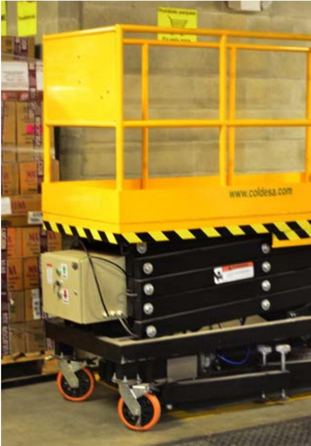
El Manlift Coldesa es una plataforma elevadora que mediante un principio hidráulico permite ascender y realizar trabajo en altura de una manera segura y eficiente. Los Manlift Coldesa son una solución para realizar trabajos en altura que permite localizar en varias posiciones continuamente disminuyendo considerablemente los tiempos que requiere el posicionamiento de escaleras y desmontaje de andamios, agilizando las actividades realizadas en alturas.
